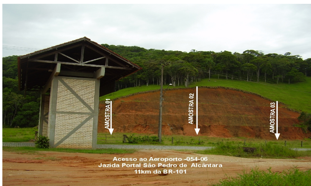
Figura 5.1 - Caixa de empréstimo junto ao Portal de São Pedro de Alcântara, com os pontos de coleta de amostras assinalados.
