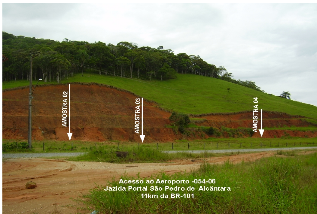
Figura 5.2 - Caixa de empréstimo junto ao Portal de São Pedro de Alcântara, com os pontos de coleta de amostras assinalados.
